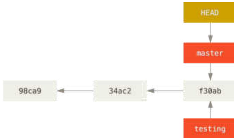
Рис. 4.3. Дві гілки вказують на одну послідовність фіксацій. HEAD вказує на поточну гілку
