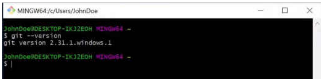
Рис. 5.21. Перевірка установки Git
